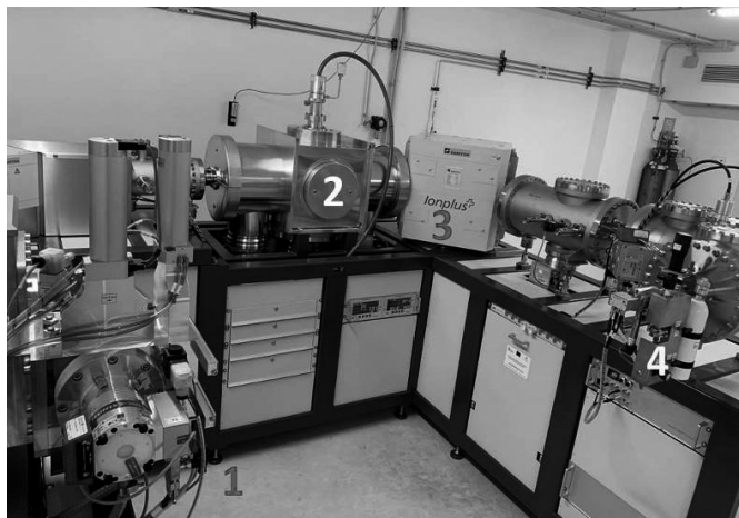
Figura 6. Espectrómetro masas AMS de la Universidad de Salamanca. Componentes principales: 1, Fuente de iones. 2, Acelerador. 3, Campo magnético de alta energía. 4, Detector ^{14}\text{C} .
